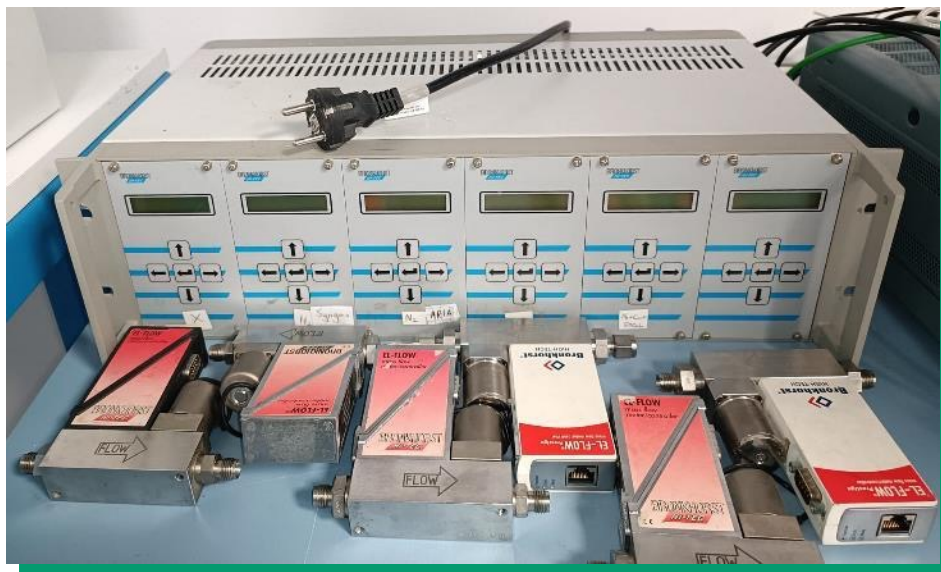
Sistema di gestione Bronkhorst con i relativi 6 mass flow controller
